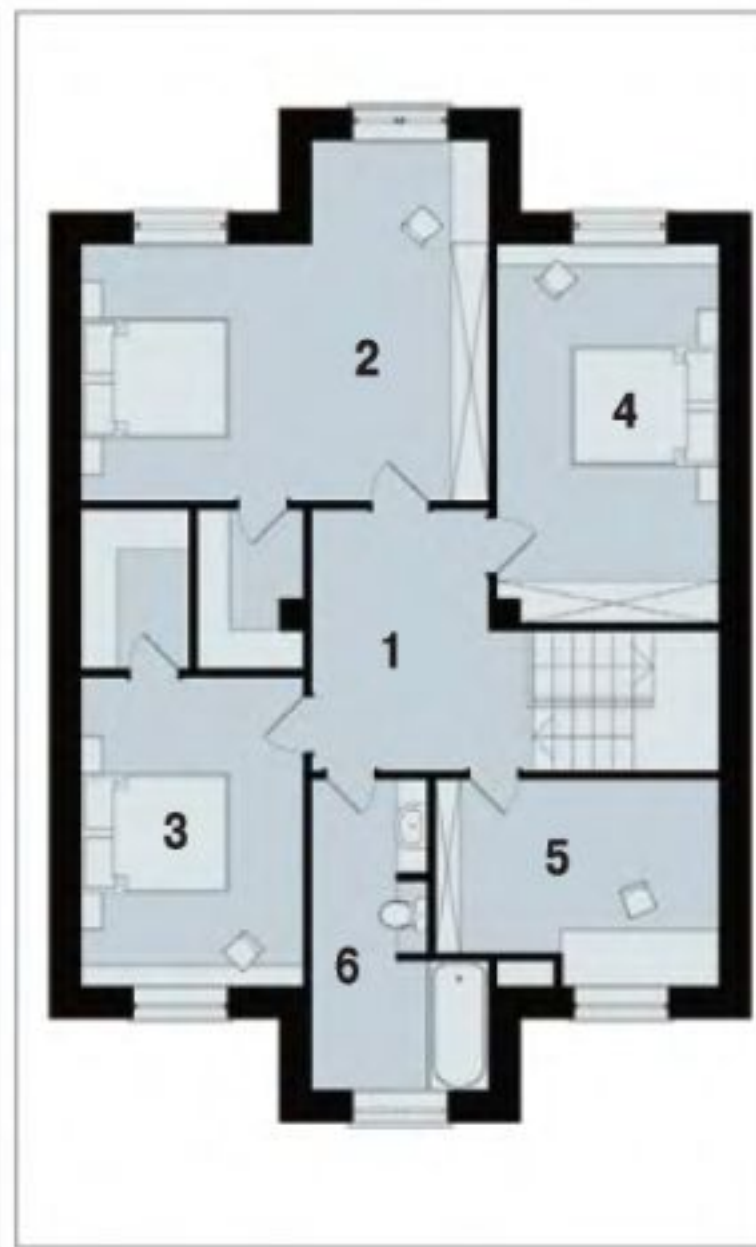
Рис. 3. План мансарды нового дома: 1 — холл 9,2 м 2 ; 2 — спальня с гардеробной 22,5+3,1 м 2 ; 3 — спальня с гардеробной 12,7+3,1 м 2 ; 4 — спальня 15,4 м 2 ; 5 — кабинет 10,0 м 2 ; 6 — ванная 8,1 м 2 .
