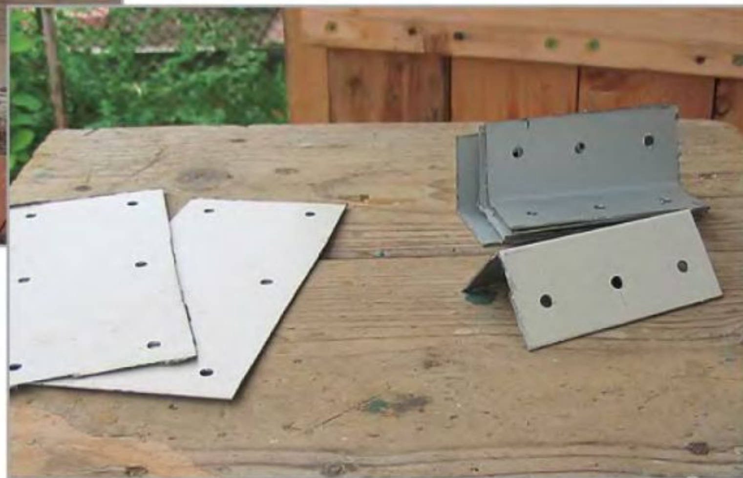
Кожух корпуса персонального компьютера и вырезанные из него крепёжные пластины и уголки.
