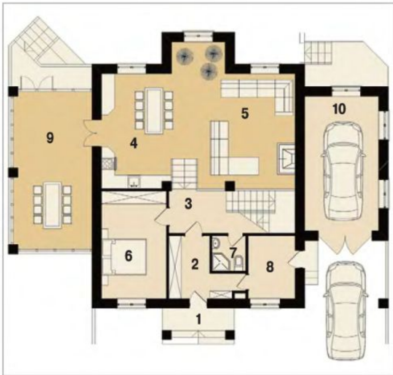
Рис. 2. План 1-го этажа нового дома: 1 — крыльцо главного входа; 2 — тамбур-прихожая 6,8 м 2 ; 3 — холл 10,6 м 2 ; 4 — кухня-столовая 15,8 м 2 ; 5 — гостиная 31,5 м 2 ; 6 — спальня 13,9 м 2 ; 7 — сан-узел 2,4 м 2 ; 8 — котельная 5,9 м 2 ; 9 — веранда 24,0 м 2 ; 10 — гараж 19,8 м 2 .
