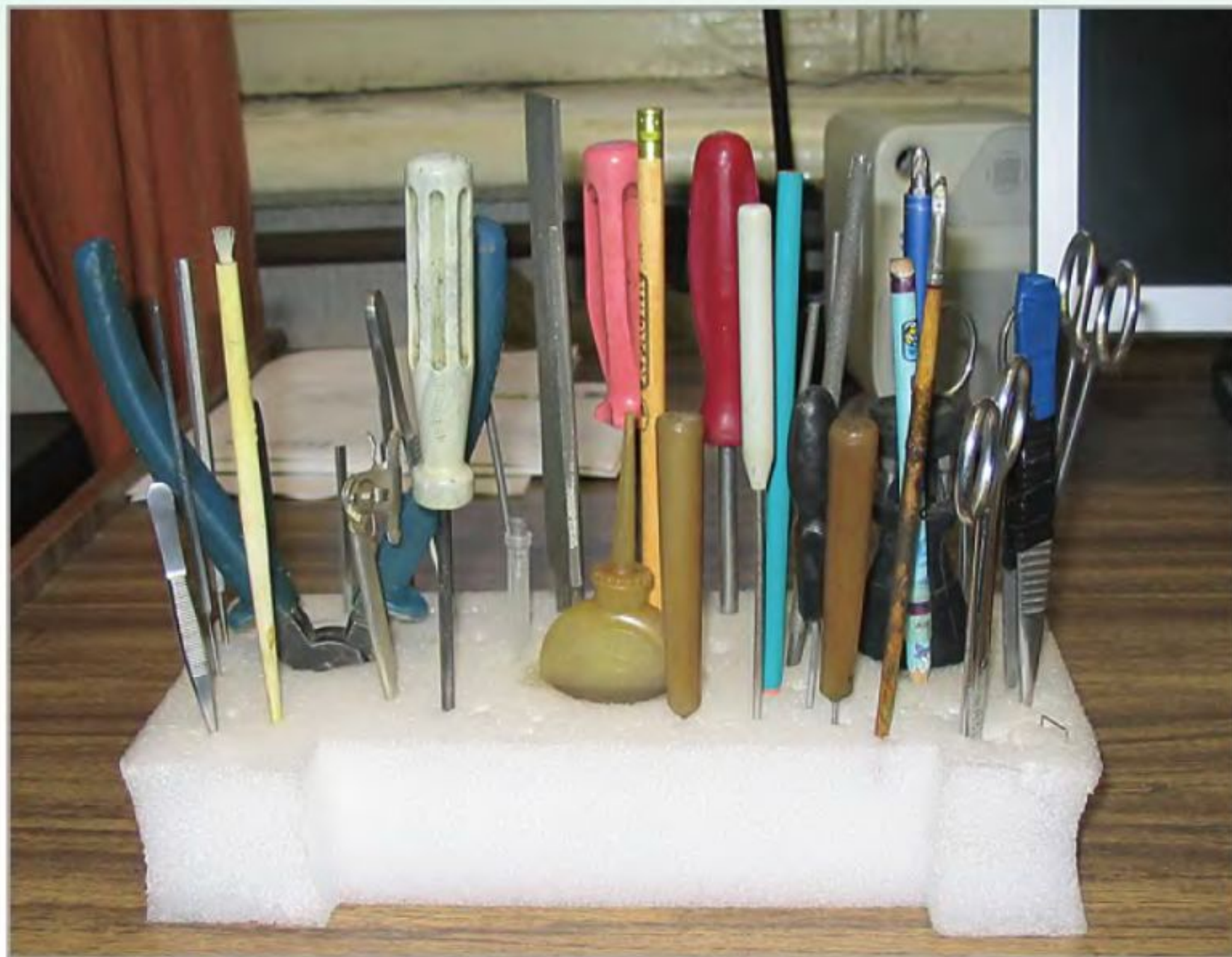
Держатель для инструмента. Для более крупных инструментов отверстия должны быть больше.
